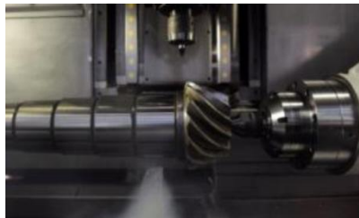
Abbildung 12: Fertigdrehen gehärteter Stahlwellen
