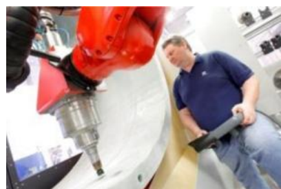
Abbildung 9: Composite-Bearbeitung eines Windflügelendstückes
