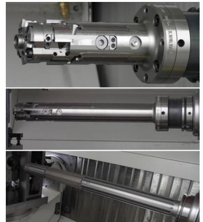
Abbildung 7: Feinbohren und Honen von Kurbelgehäusen
