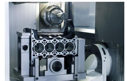
Abbildung 1: Feinbohren und Honen auf Bearbeitungsmaschinen in einer Aufspannung
