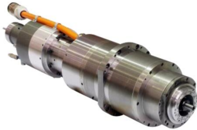
Abbildung 2: Elektromechanisch betätigte Spindeleinheit mit Zug-Druck-Stange
